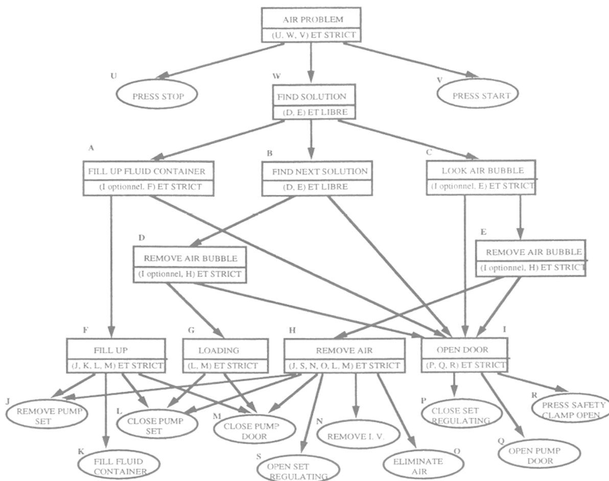
Figure 2. Arbre des tâches pour le problème d'air. Pour des questions de visibilité, le dessin est un graphe, mais la structure sous-jacente est bien un arbre : les nœuds similaires sont dupliqués
